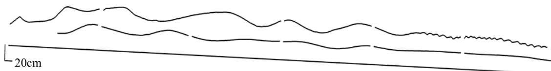
図1 イリノイ大学のヘッドタンク全量(サージ1回の単位幅総流量約 5.87L)のトレース画像。0回目、20回目、40回目のトレースを 10cm 間隔で重ねた。縦方向を 2 倍に強調。水路の全長 14.5m。スケールの各辺は 20cm。
